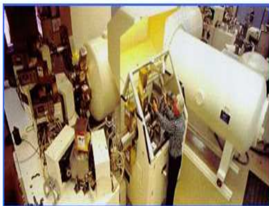
Ο επιταχυνόμενος φασματογράφος μάζας (accelerator mass spectrometer), που επιτρέπει τον καθορισμό της ηλικίας πάσης φύσεως θαλάσσιων δειγμάτων με τη μέθοδο της ραδιοχρονολόγησης (radiocarbon dating). Μια από τις υποδομές του WHOI που χρησιμοποιούνται από ομάδες επιστημόνων από ολόκληρο τον κόσμο.
