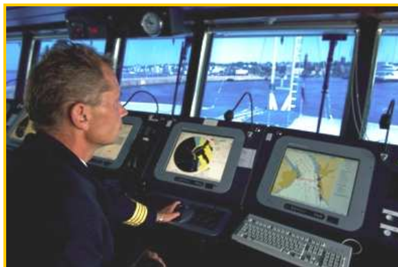
Γέφυρα ναυσιπλοΐας με το σύστημα ECDIS να διακρίνεται δεξιά
