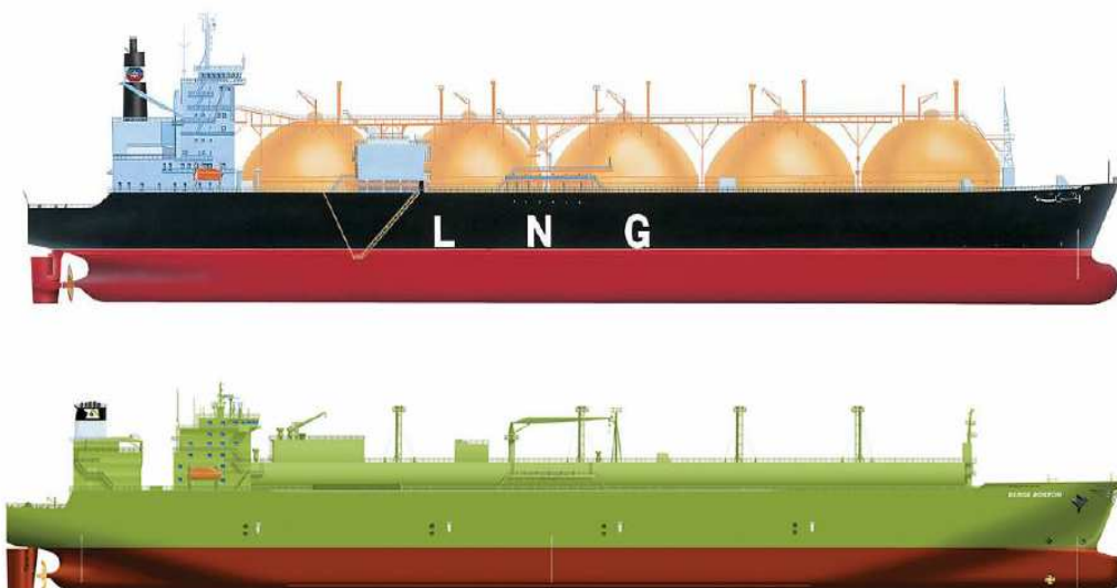
Εικόνα 1 Οι δύο βασικοί τύποι πλοίων LNG με σφαιρικές, ανεξάρτητες δεξαμενές (πάνω) και συνδεδεμένες στην κατασκευή δεξαμενές τύπου μεμβράνης (κάτω).
