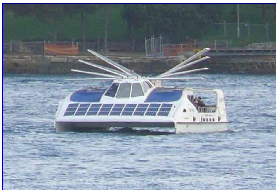
Το catamaran Solar Sailor στο οποίο διακρίνονται τα 8 φωτοβολταϊκά panels – ιστία κατά τη διάρκεια δοκιμών στο Sydney της Αυστραλίας το 2000
