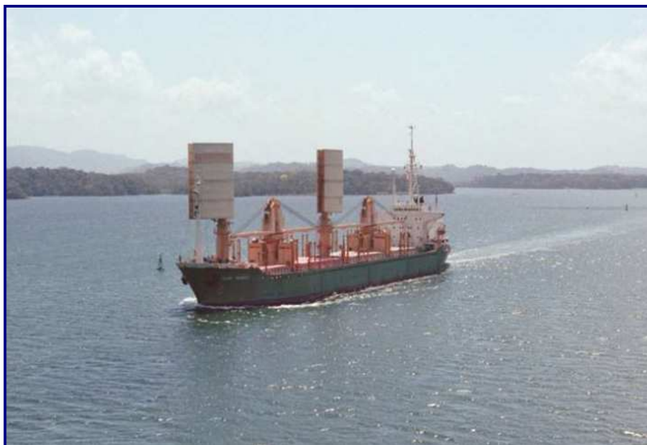
Το 165 μέτρων μήκους και χωρητικότητας 26.000 κόρων φορτηγό πλοίο Usuki Pioneer αποτελεί ένα από τα πρώτα εμπορικά πλοία που χρησιμοποίησαν την αιολική ενέργεια
